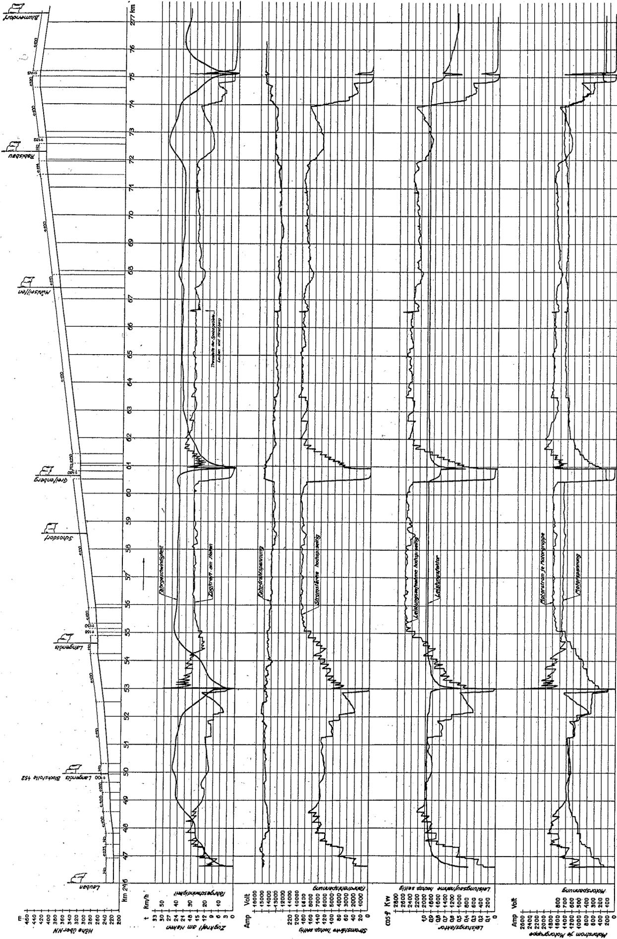
Abb. 13. Meßfahrt am 29. IV. 1925 mit C-C-Lokomotive, 120 t Gewicht, und Güterwagen, 1400 t Gewicht, 115 Achsen.
